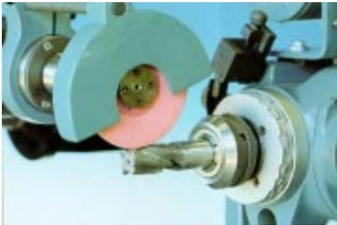
SCREW SLOT SURFACE GRINDING
